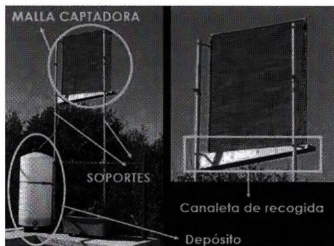
Gráfico 2 Partes de un atrapanieblas
