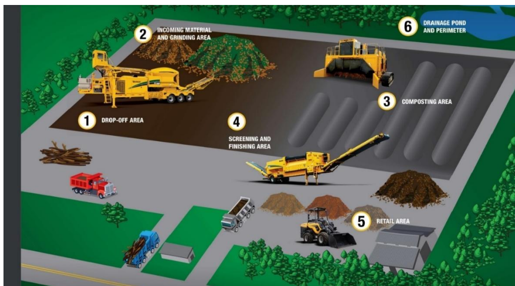
Distribución de una planta de compostaje
