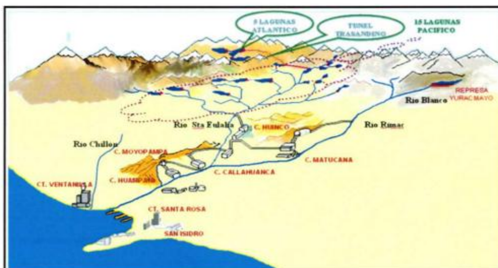
Figura 3: Representación del Sistema Regularizado del Río Rímac
