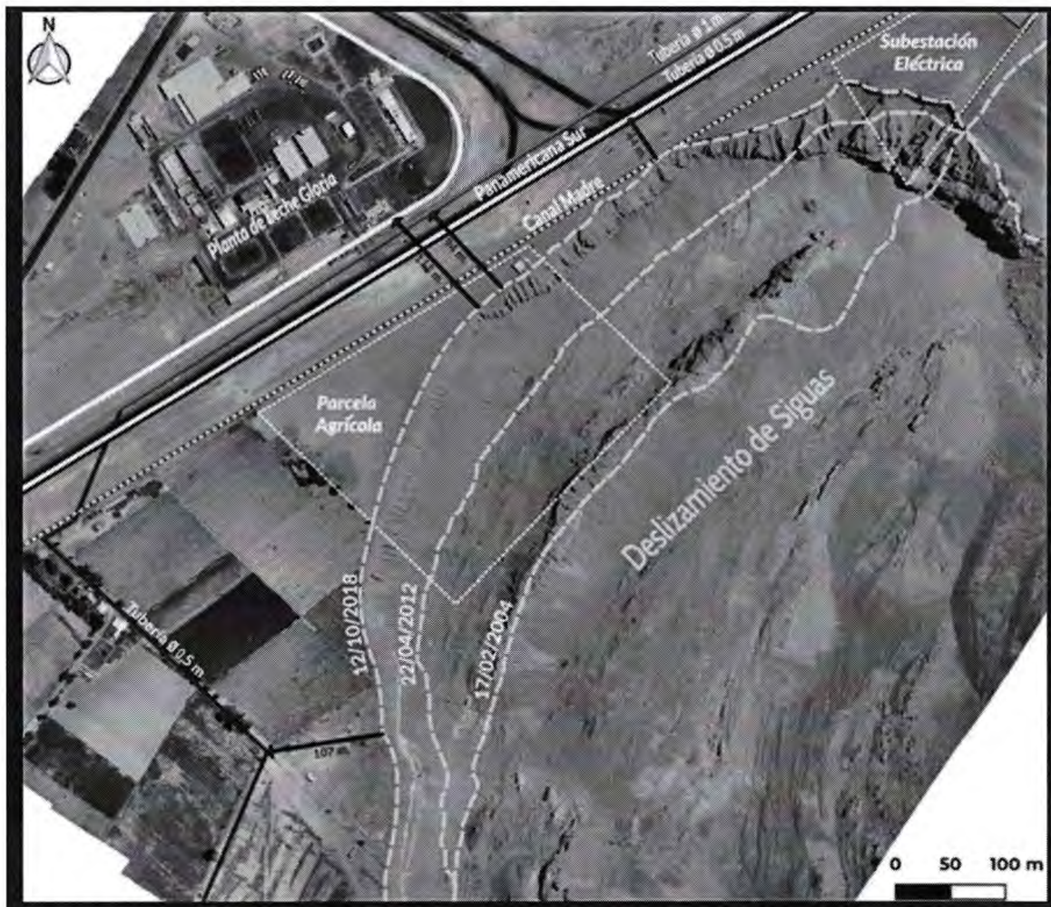
Avance de deslizamientos a causa de excesivo riego en Majes I
